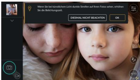
Fotografiert man bei Kunstlicht mit kurzen Belichtungszeiten, kann ein Flackern auftreten, das sich in den Bildern als schwarze Streifen zeigt.
