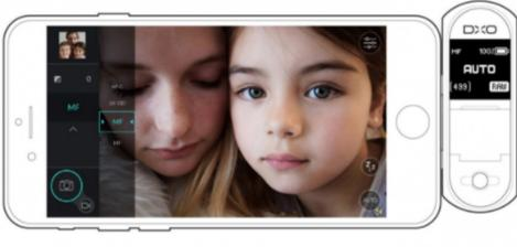
Une réglette de mise au point s'affiche à gauche de l'écran de visée, graduée de la mise au point minimale (20 cm) jusqu'à l'infini. Placez le doigt sur la réglette et ajustez la distance de mise au point en balayant vers le haut ou le bas.
